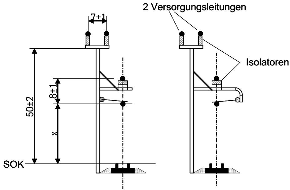
Abbildung 1: Mast mit zwei Versorgungsleitungen (Funktionsmaß  $x$  ist in Zm-Norm 001 definiert)
